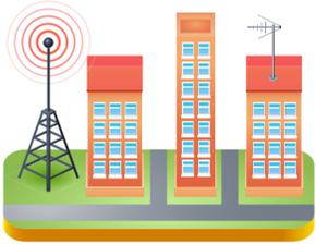
Плотность застройки местности (между передающей антенной телецентра и местом установки приемной антенны возникают экраны для радиоволн – высокие здания)
