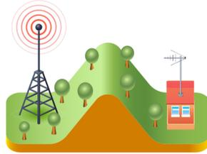
Рельеф местности (сложные условия приема возникают в низинах, в районах с сильно пересеченным рельефом местности, непосредственно за лесными массивами и железнодорожными насыпями)
